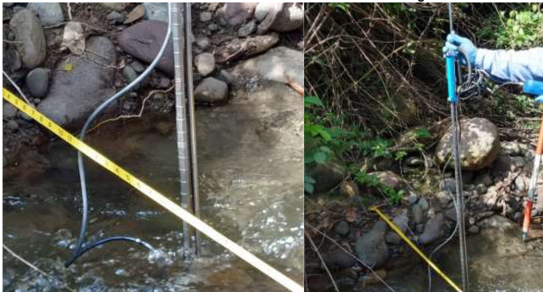
Fotografía No 2. El equipo que se utilizó para la medición de caudales, fue mediante aforos directos con molinete hidrométrico OTT – C 2 de última generación.
